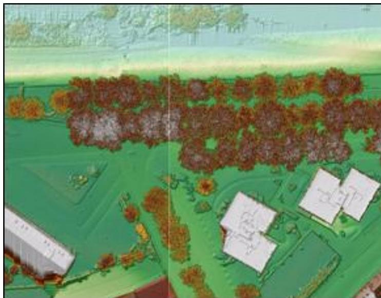
**Figure 4** : Modèle Numérique de Surface (MNS) d'une digue et de ses abords, à la grille de 10 cm, comprenant la topographie, la végétation et le bâti (source : projet FloodProBE, site pilote du Val d'Orléans).
