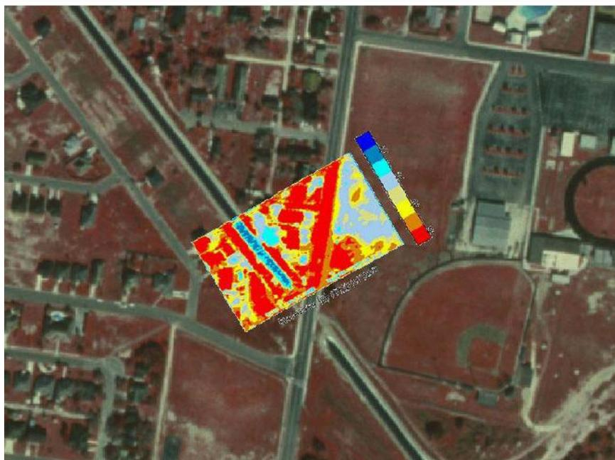
*Exemple de mesure aéroportée. Une fuite dans un canal est clairement identifiée (côté droit) et confirmée sur le terrain, d'après Huang, 2002.*
