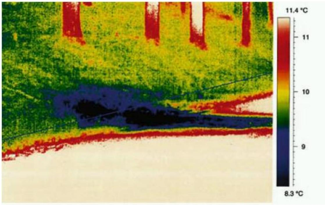
*Exemple d'imagerie thermique : une digue (verte), sur laquelle des arbres ont été plantés (rouge), protège une route (crème) de l'eau d'un canal. Une fuite, plus froide, apparaît clairement en bleu, l'eau s'écoulant jusque sur la route. D'après Morawetz, 2007.*
